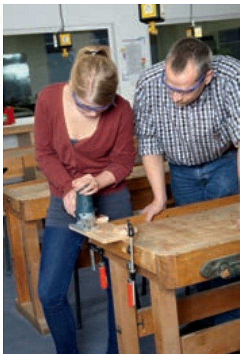
Bei umfangreichen Arbeiten mit von Hand geführten Maschinen kann auch eine Absaugung erforderlich werden.
